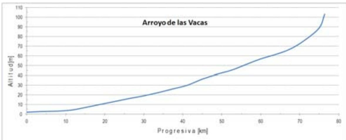
Figura 8.- Curva hipsométrica del arroyo de las Vacas.
